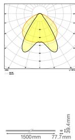
**Technische Daten Ledvance LED Tragschiene Trusys Flex Klar Stahl Weiß 70W 12100lm 2x30D - 840 Kaltweiß | 3 Stunden Notbeleuchtung**
