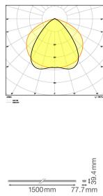
**Caractéristiques Ledvance LED Rail de fixation suspendu Trusys Flex Claire 35W 5800lm 90D - 840 Blanc Froid | Dali Dimmable**
