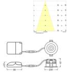
Caractéristiques Ledvance Spot LED Fix Aluminium Blanc 8W 720lm 36D - 940 Blanc Froid | Diamètre 68mm - IP44 - Meilleur rendu des couleurs - Dimmable
