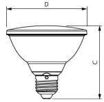
**Caractéristiques Philips Master Value LED ampoule Réflecteur E27 PAR30 9.5W 740lm 25D - 927 Blanc Très Chaud | Meilleur rendu des couleurs - Dimmable - Équivalent 75W**
